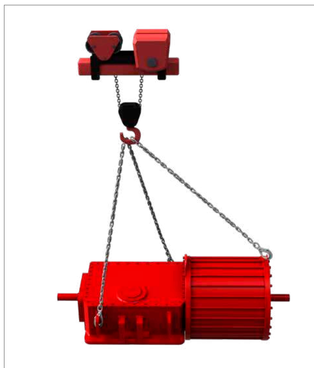
Abb. 7.4 Anheben (doppelt wirkender Stellantrieb der Größen 200-350)
