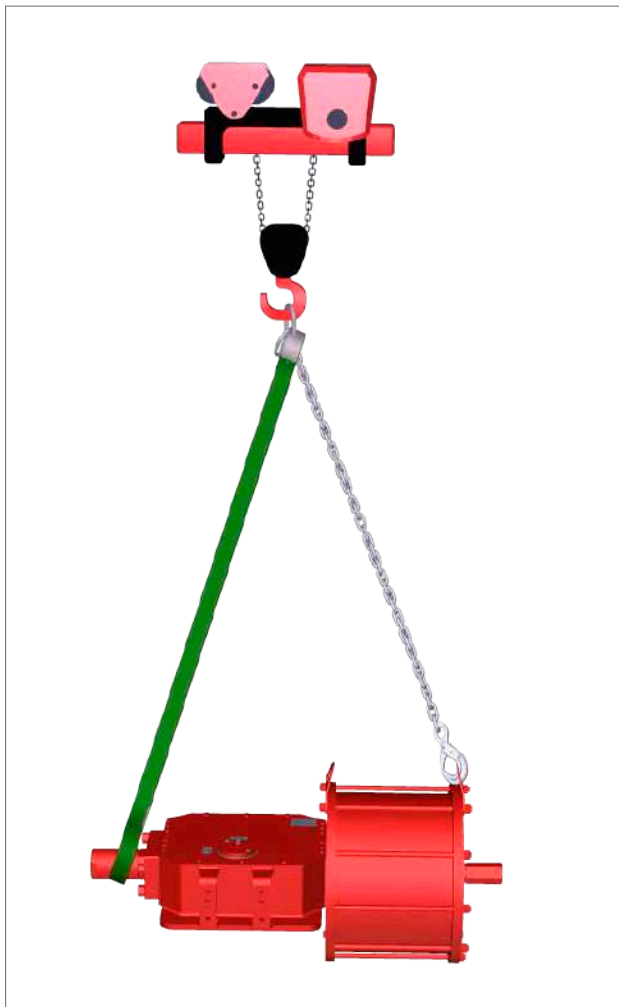
Abb. 7.2 Anheben (doppelt wirkender Stellantrieb bis Größe 161)
