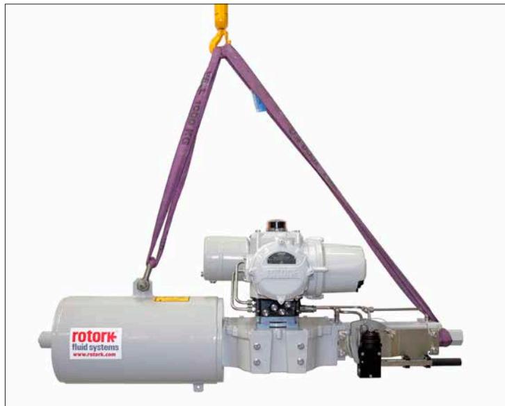
Рис. 4.1.1. Подъём SI3: Стропы закреплены за проушину и крышку стопорного болта гидравлического цилиндра.
