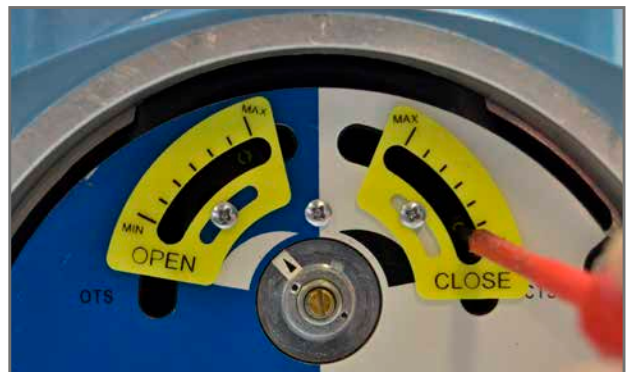
Réglage du couple de fermeture.
