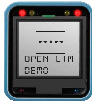
Indication de la limite d'ouverture Centronik.
