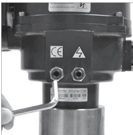
Kalibracja śruby krańcowej zamykania dla zaworu o lewoskrętnym kierunku zamykania
