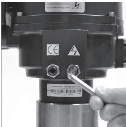
Kalibracja śruby krańcowej zamykania dla zaworu o prawoskrętnym kierunku zamykania
