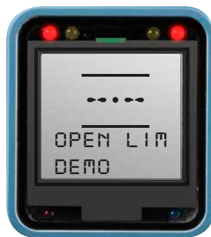
Indicazione del limite di apertura di Centronik.
