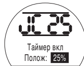
Таймер настроен на включение импульсного режима, когда закрывающаяся арматура достигнет 25 % открытия
