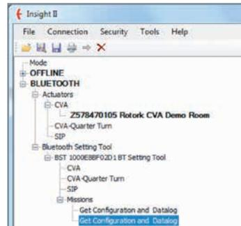
Depois de completar a função, a ferramenta pode ser configurada no modo inativo pressionando as teclas +/- simultaneamente ou usando a função desconectar do Insight 2. A missão agora pode ser executada seguindo as instruções da seção Executar Missão na página 9.
