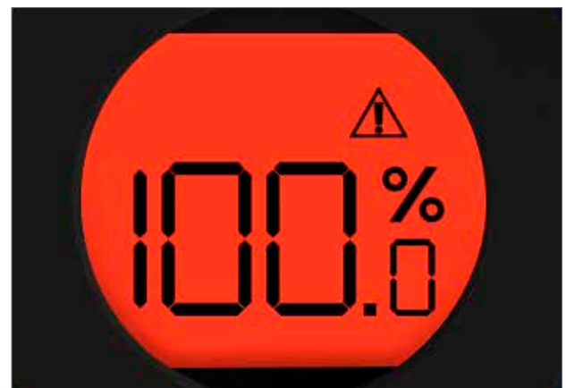
Abb. 4.7 Stellantrieb blinkt abwechselnd rot und weiß im Falle eines Stromausfalls
