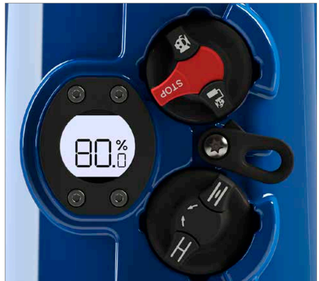
Abb. 8.2 Stellantrieb in Position 'STOP'
