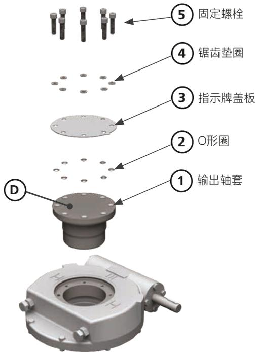
图1 - 输出轴套布置图
