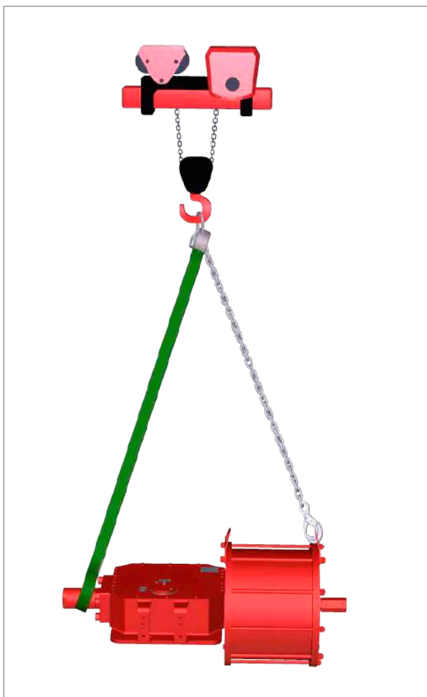
Fig 7.2 Løft (dobbelvirkende aktuator op til størrelse 161)
