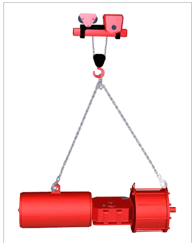
Fig 7.1 Løft (enkeltvirkende aktuator op til størrelse 161)
