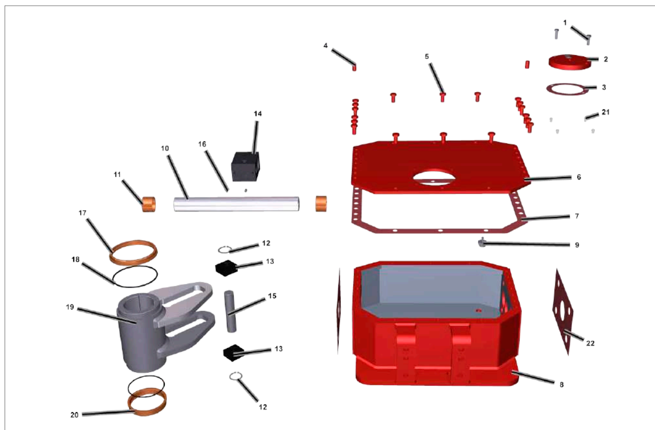
Fig 17.3 Midterkrop (svejset) (Aktuator størrelse 065, 85, 100, 130, 161, 350)
