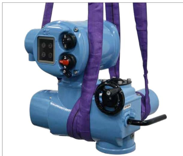
スリングによるCKアトロニックの吊り上げの様子
