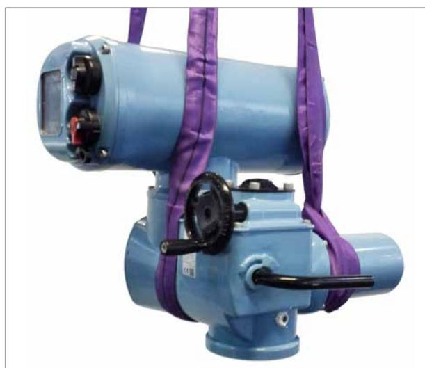
スリングによるCKセントロニックの吊り上げの様子
