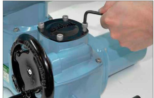
ステム上昇バルブの場合、カバーチューブが取り付けられていることがあります。この場合もまたO-リングと六角穴付きボルトでしっかり締め付けて下さい。
