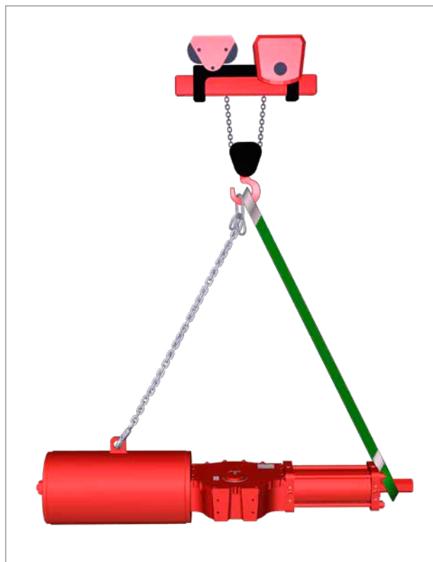
Рис. 7.1 Подъём (привода одностороннего действия до размера 161)
