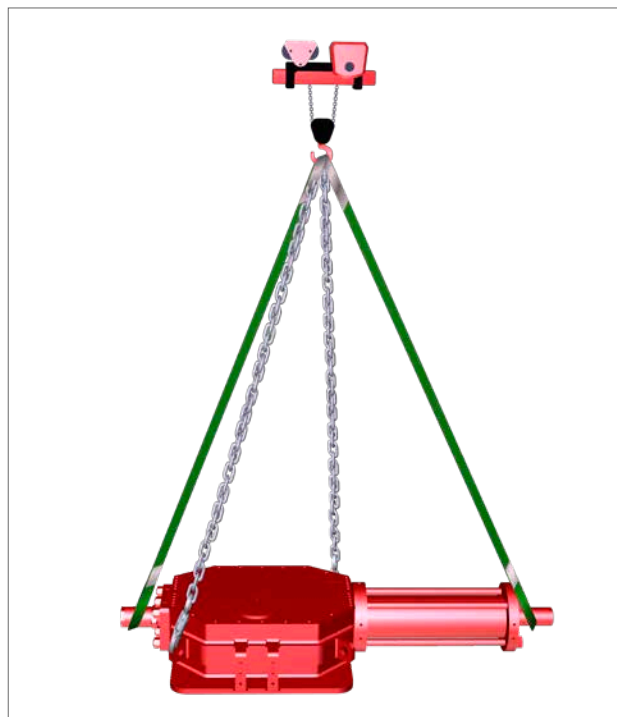
Рис. 7.4 Подъём (привода двустороннего действия размера 200 - 350)
