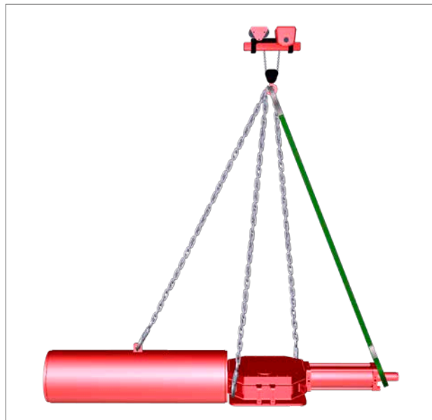
Рис. 7.3 Подъём (привода одностороннего действия размера 200 - 350)
