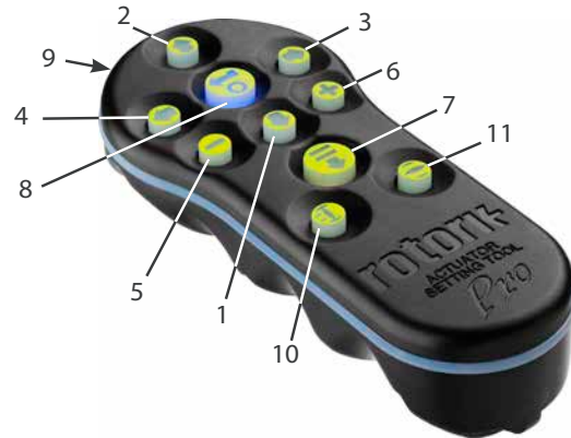
Рис. 7.4. Пульт настройки Rotork Pro v1.1 с Bluetooth®
