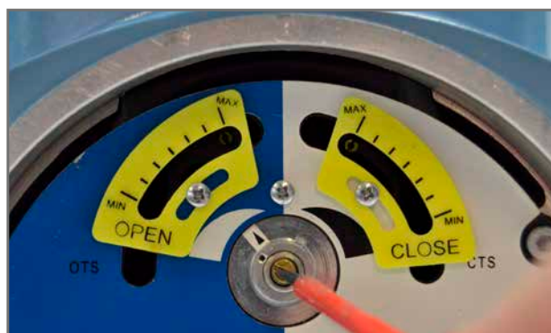
Настройка винта сцепления кулачка.
