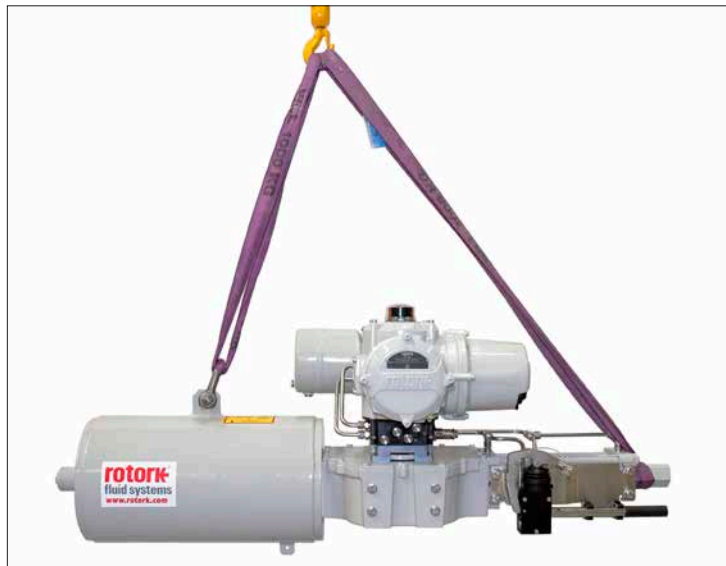
Kuva. 4.1.1. Liinat kiinnitettyinä toimilaitteen korvakkeeseen ja hydraulisyliinterin päättyyn.
