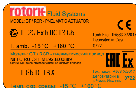
Εικ. 5.3 Ετικέτα ενεργοποιητή ATEX/EAC για υψηλή θερμοκρασία (-15 °C < T < +160 °C)
