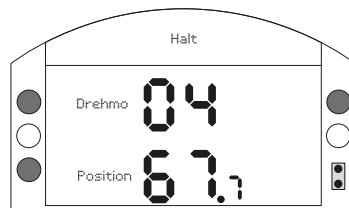
Abb. 4.4.3 Drehmoment (D) + Stellung
