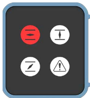
Wskazanie pozycji otwartej na sterowniku Atronik
