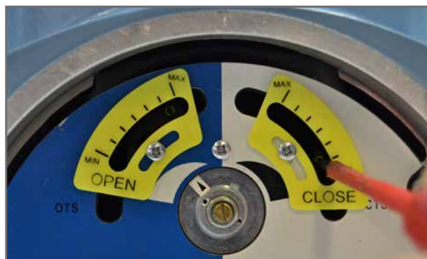
Nastawa wyłącznika momentowego
