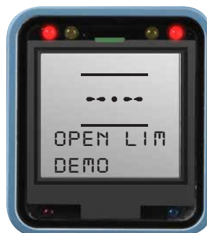
Wskazanie pozycji otwartej na sterowniku Centronik
